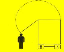
POSITION TARP FLUSH AGAINST SIDE OF TRAILER BEFORE LOADING. ENSURE TARP IS RESTING COMPLETELY ON TOP OF TRAILER PRIOR TO MOVING TRAILER.
